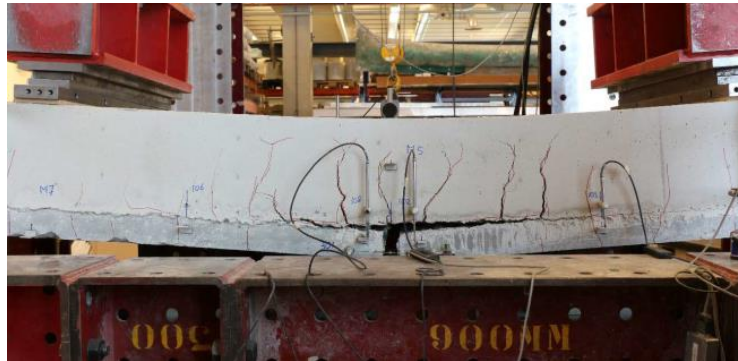
Figuur 2.3: Bezwijken na vloeien van de koppelwapening, proefstuk R2 (Hageman 2019) met detailleringwijze I.
