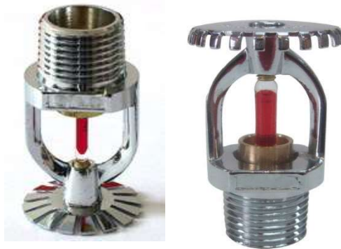
Figuur 6. Hangende en staande sprinklerkop. De glasbulb is hierin het thermische element, de feitelijke detector.
