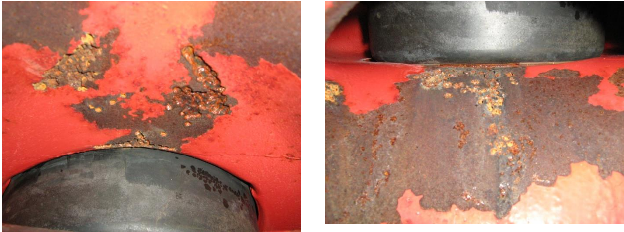
Figuur 11: Cavitatieschade PSV.
