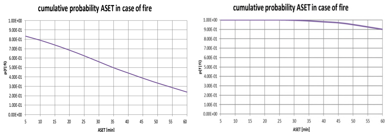
Figuur 20: Cumulatieve kansverdeling ASET in corridor, criterium overleefbaarheid, met vast tijdstip van openen deur brandruimte (5 minuten) (links: ongesprinklerde referentiesituatie; rechts: gesprinklerde situatie)
