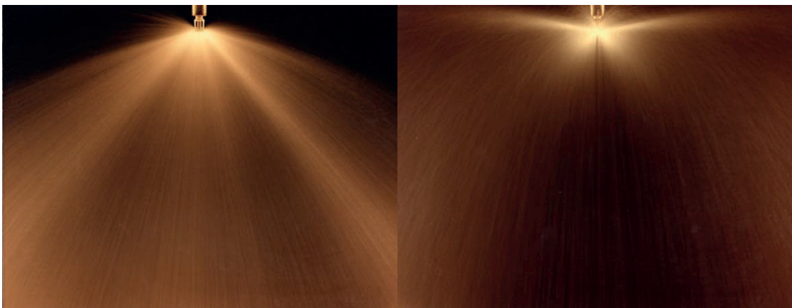
Links sproeipatroon conventionele sprinkler versus rechts sproeipatroon woningsprinkler
